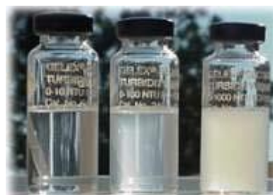
Mostre de turbiditate standard: 5, 50 și 500 NTU.
